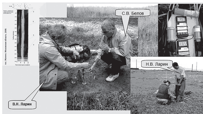
Рис. 3. Натурные замеры водорода с помощью газоанализаторов в ходе реализации раздела 1.3.1 программы № 14 Президиума РАН
